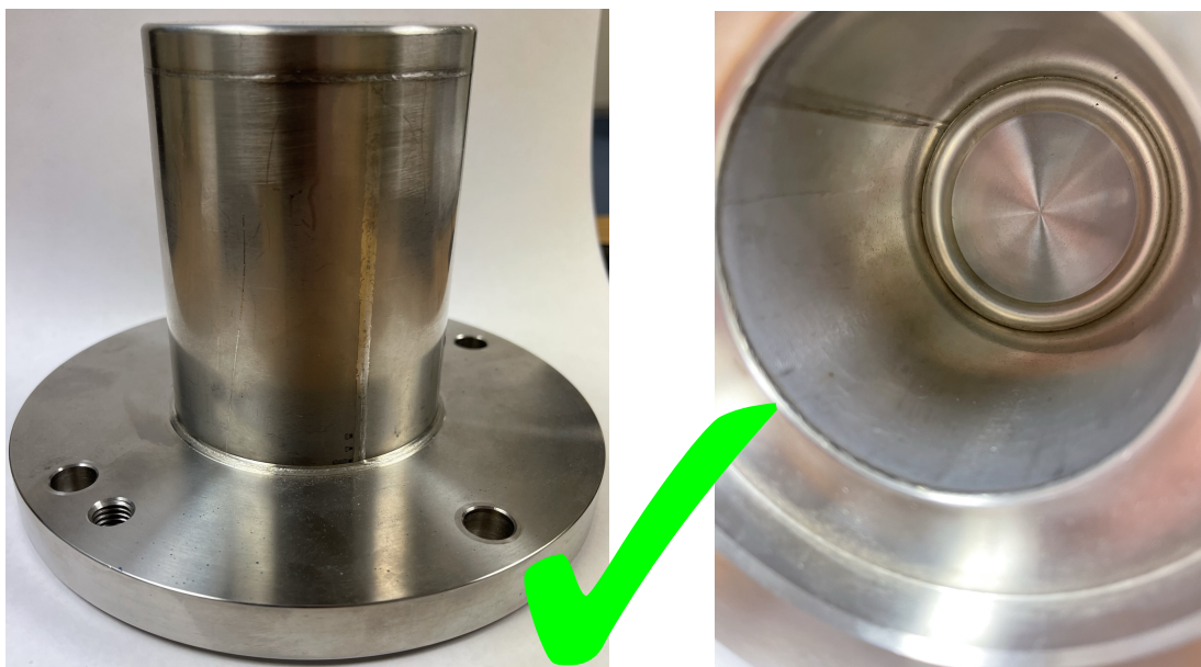
Fig. 11: piatto separatore A sinistra: superficie esterna priva di scanalature A destra: parte interna priva di scanalature
