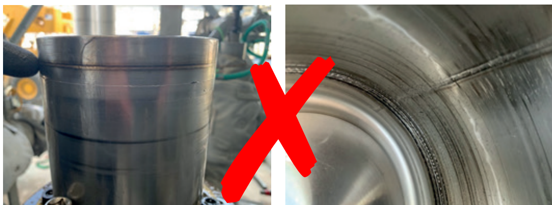
Fig. 12: Pot de confinement Gauche : La rainure s'étend sur toute l'épaisseur de la paroi A droite : plusieurs rainures profondes successives
