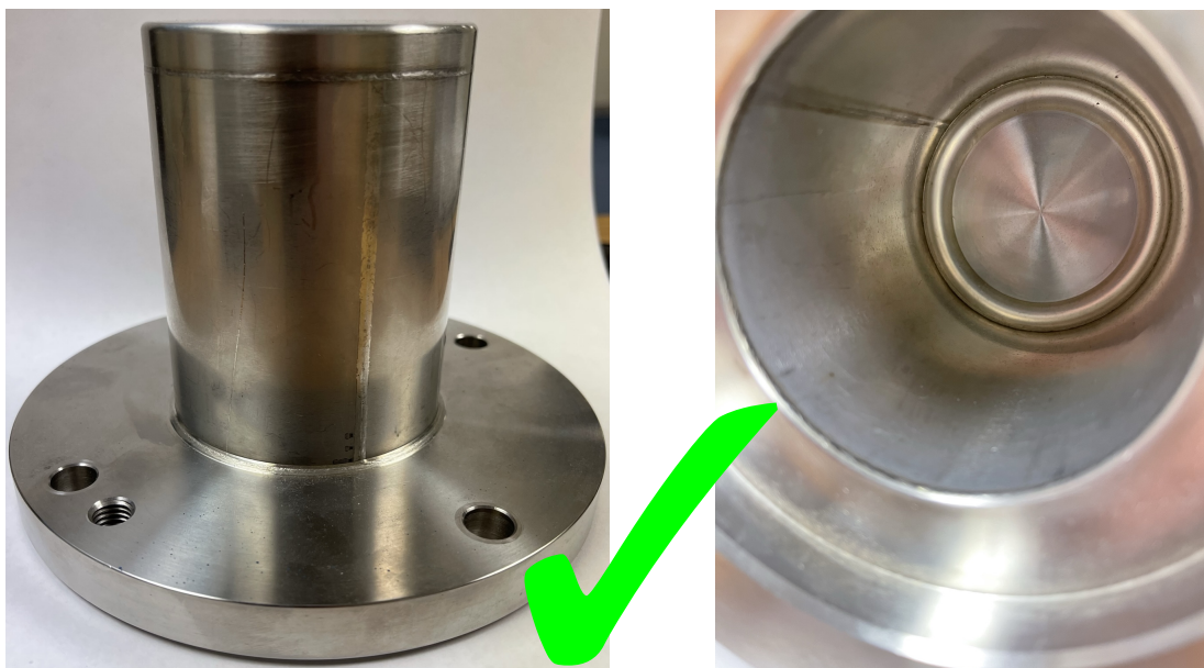
Fig. 11: Pot de confinement Gauche : Surface extérieure exempte de stries Droite : Face intérieure exempte de rainures
