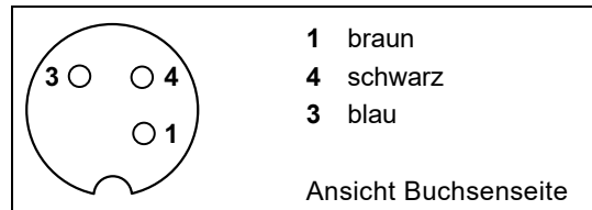
Abb. 26 Steckerbelegung BEG 56A
